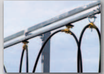
Sistema di collegamento aereo dei tubi.
