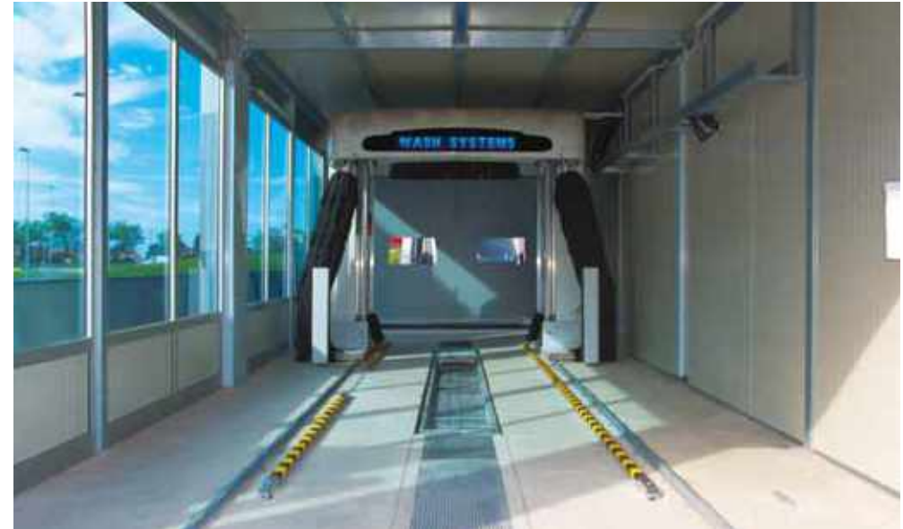
Interno portale lavaggio Inside the rollover
