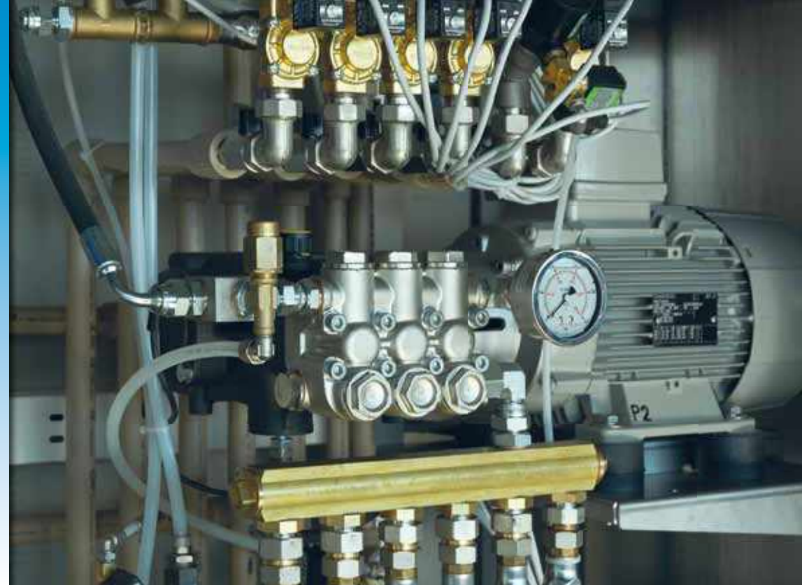
Particolare pompa alta pressione con regolazione elettronica pressione High pressure pump with electronic control
