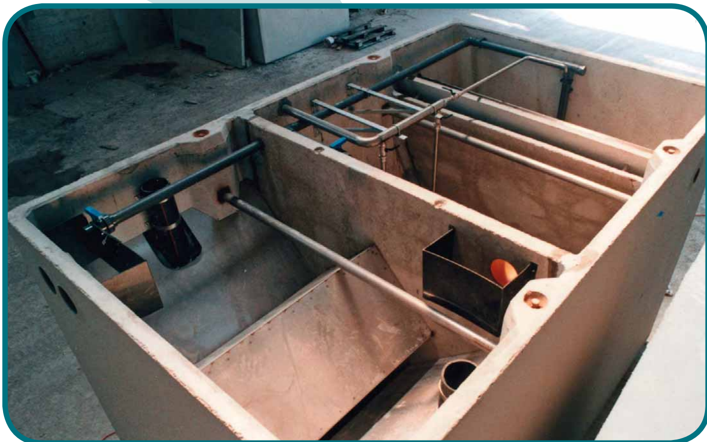
Vista parte interrata depuratore con sezione Imhoff e sezione di ossidazione Prefabricated underground tank provided with Imhoff section and oxydation section
